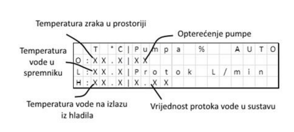
Slika 18 Prikaz elemenata glavnog zaslonskog sučelja sustava za automatsko upravljanje
