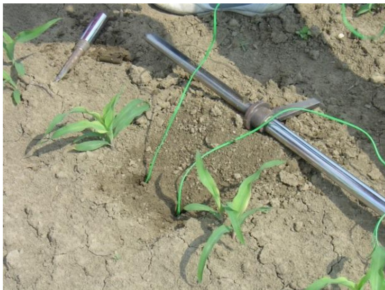
Slika 7 Određivanje vlažnosti tla pomoću sonde Watermark (Poljoprivredni institut Osijek)
