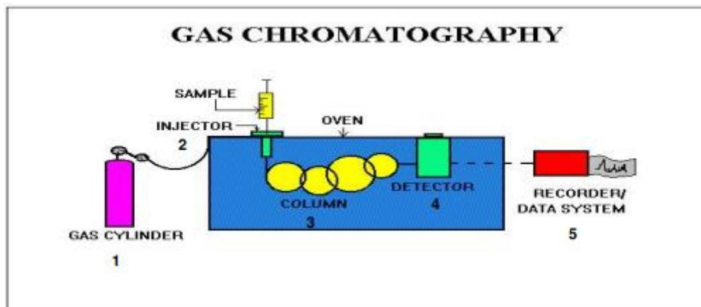
**Slika 11** Shematski prikaz sustava za plinsku kromatografiju (Web 13)
