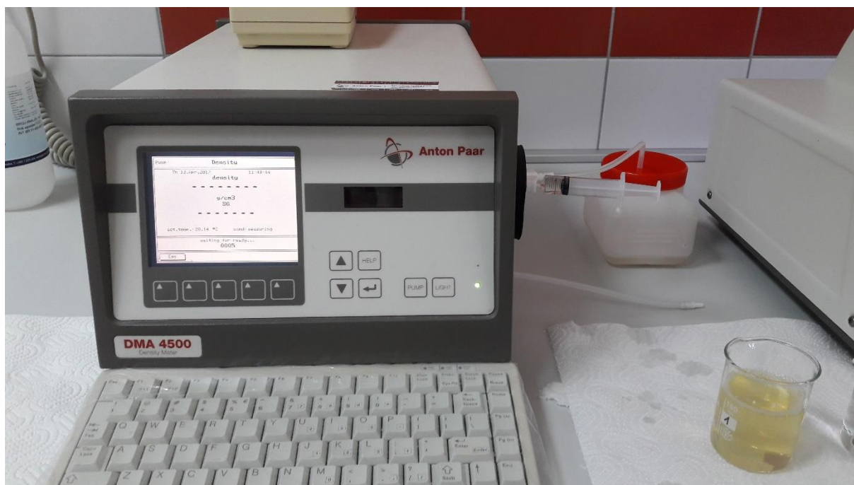
Slika 7 Određivanje gustoće sladovine dobivene kongresnom metodom
