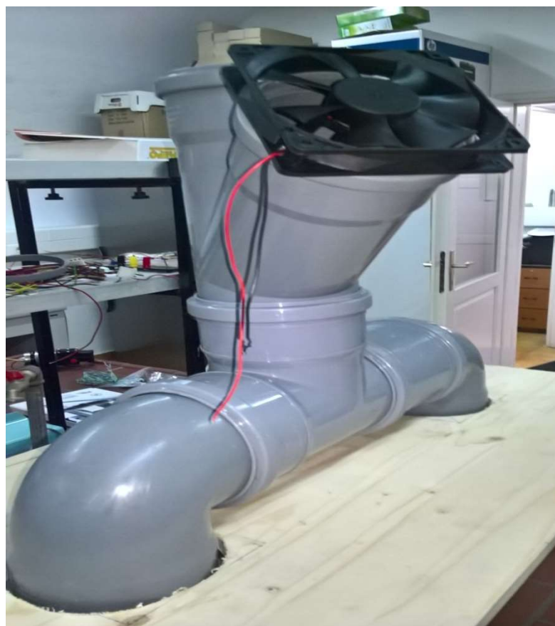
Slika 12 Ventilator pričvršćen na rub cijevi
