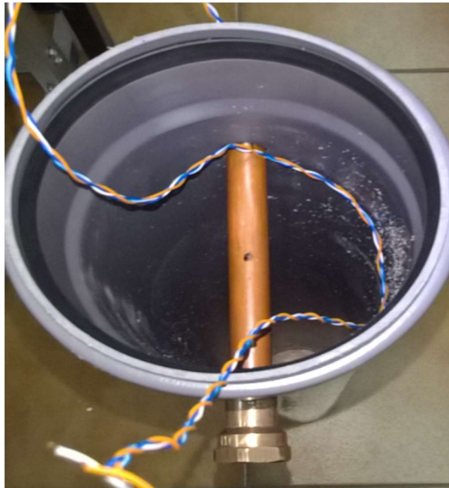
Slika 16 Prikaz probušene bakrene cijevi radi postizanja efekta tuša
