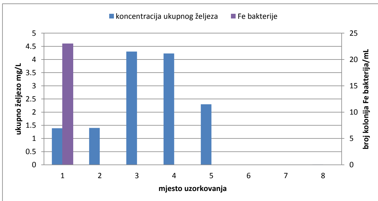
Slika 38 Ovisnost pojavnosti željeznih bakterija o koncentraciji ukupnog željeza u vodi iz pogona za preradu vode i vodi na mjestu potrošnje pri uzorkovanju br. 2
