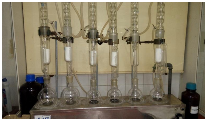
Slika 21 Ekstrakcija ulja aparaturom po Soxhletu
