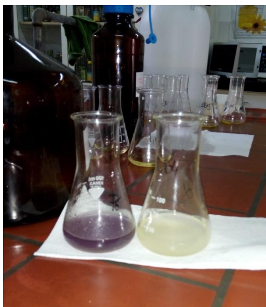
Slika 23 Promjena boje tijekom određivanja Pbr-a u ulju
