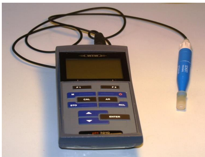
Slika 2 Prijenosni pH metar pH 3210/3310 tvrtke WTW
