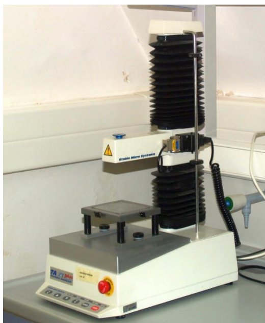
Slika 6 Stable Micro Systems TA-XT2i analizator teksture
