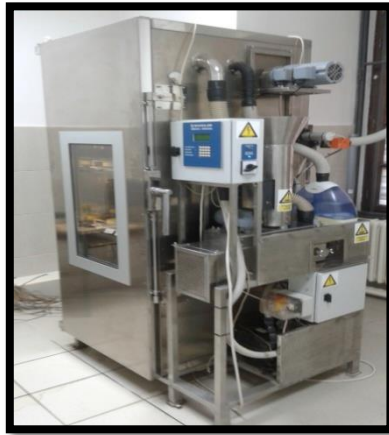
Slika 3.3. Komora za zrenje sireva
