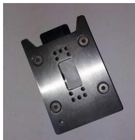
Slika 5 Čip (element mikroreaktora ugrađen u kućište)
