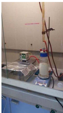
Slika 6 Sinteza biodizela u kotlastom reaktoru
