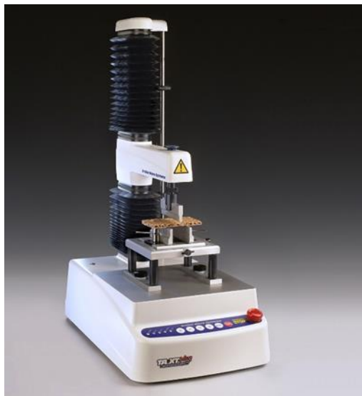
Slika 5 TA.XT Plus, uređaj za određivanje teksture
