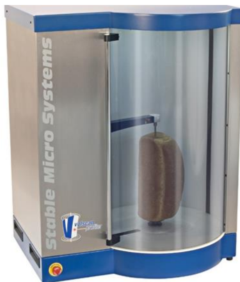
Slika 4 Volscan Profiler, uređaj za mjerenje volumena
