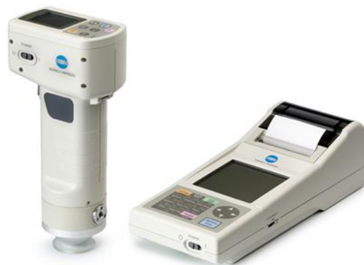
Slika 6 Konica Minolta Chroma Meter CR-400, kolorimetar
