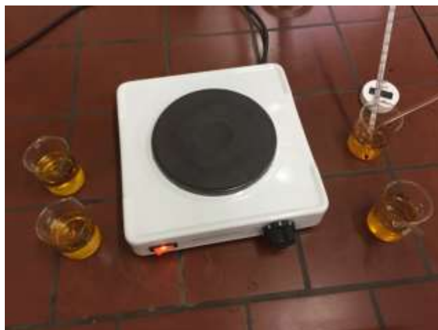
Slika 14. Zagrijavanje i miješanje uzoraka s dodanim antioksidansima na 70°C tijekom 30 minuta (Izvor: autor)
