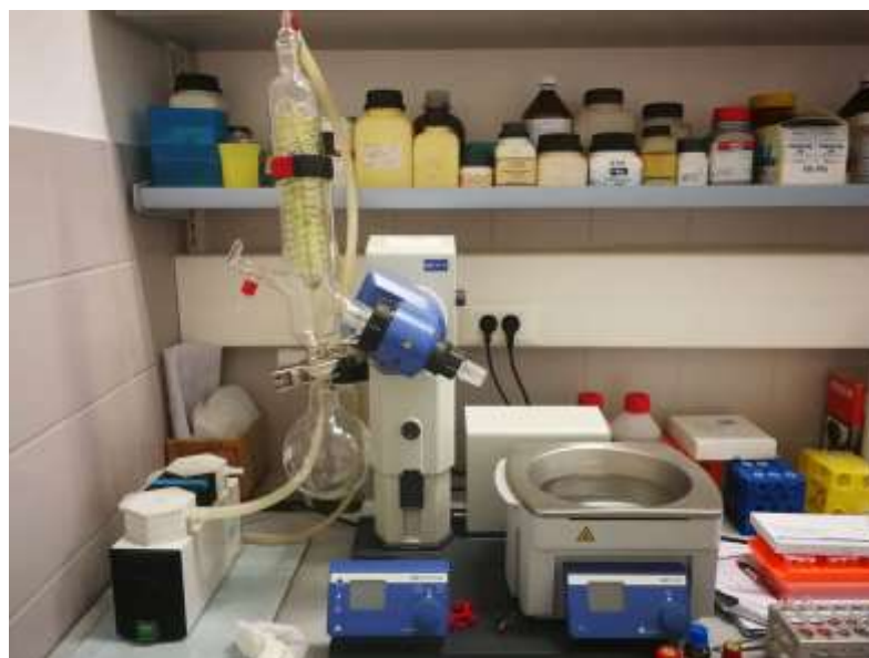
Slika 12. Rotacioni vakuumski uparivač (Izvor: Martina Jakovljević mag. nutr.)
