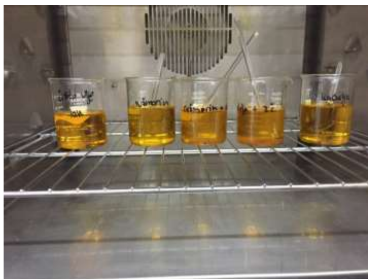
Slika 15. Pripremljeni uzorci u sušioniku za određivanje oksidacijske stabilnosti lanenog ulja (Izvor: autor)
