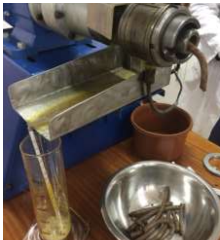
Slika 4. Proizvodnja sirovog ulja i izlaz pogače na kontinuiranoj pužnoj preši (Izvor: autor)
