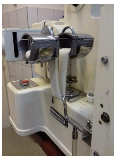
Slika 11 Rastezanje tijesta na ekstenzografu
