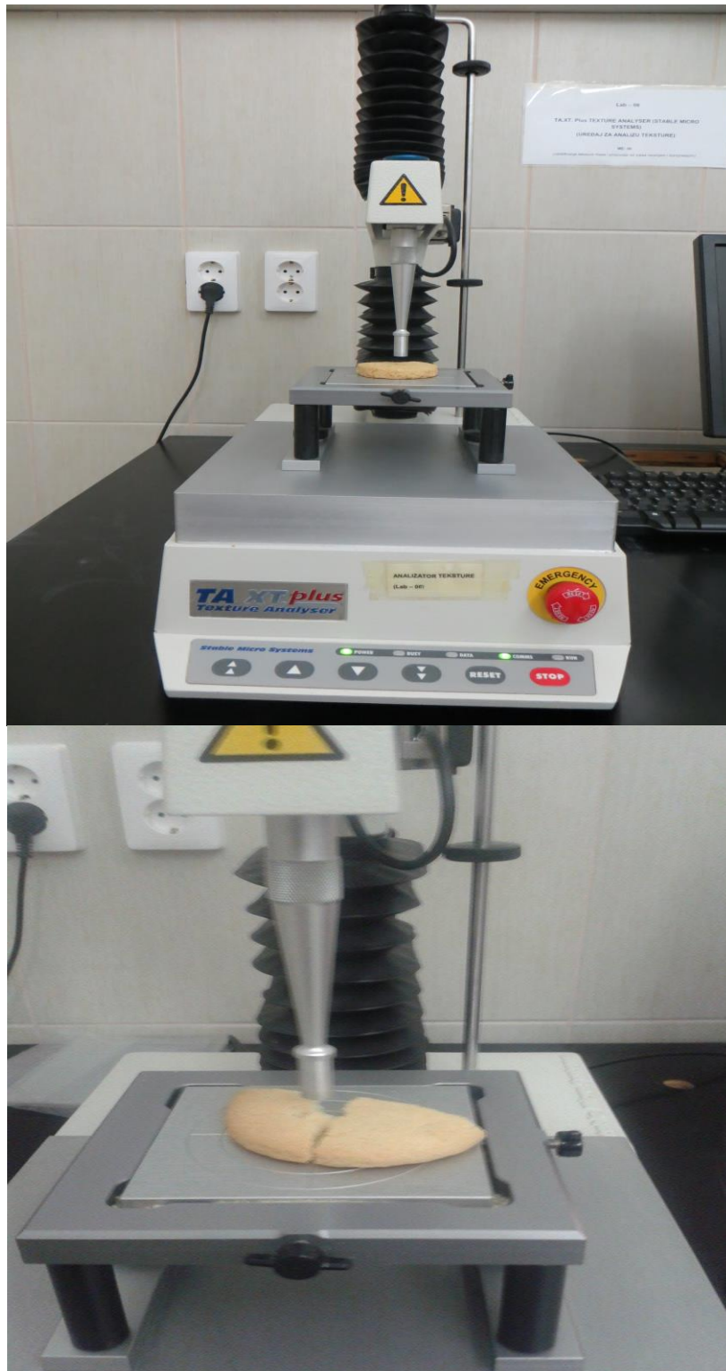
Slika 3. Analizator teksture TA.XT Plus s opremom za prodiranje u uzorak
