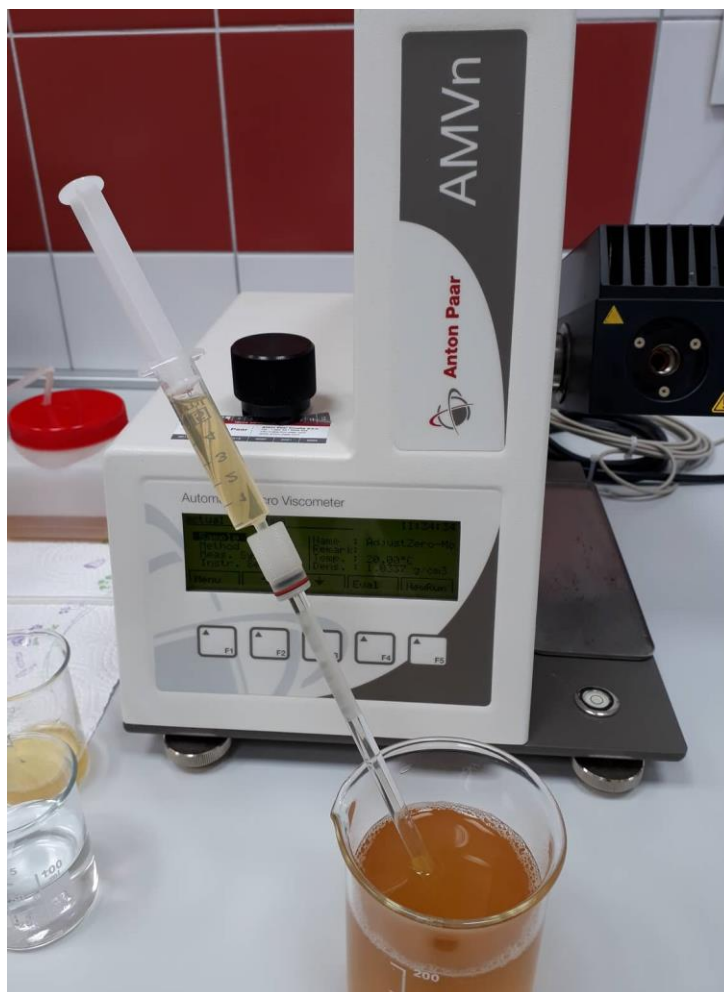
Slika 7 Uzimanje uzorka za mjerenje viskoznosti kongresne sladovine
