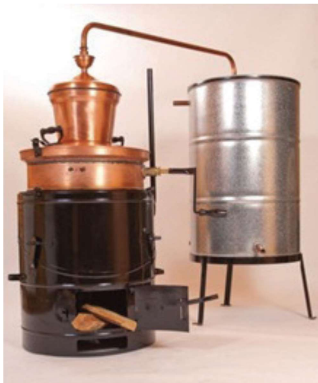
Slika 2 Tradicionalni bakreni uređaj za destilaciju (Spaho, 2017)
