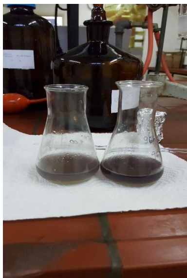
Slika 10 Titracija ulja s Na 2 S 2 O 3
