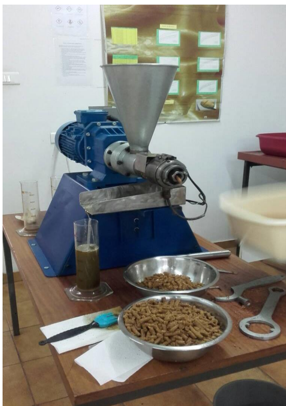
Slika 6 Proizvodnja sirovog ulja i izlaz pogače na kontinuiranoj pužnoj preši
