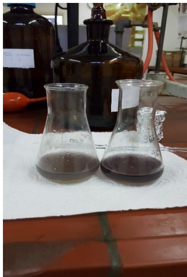
Slika 10 Titracija ulja s Na 2 S 2 O 3
