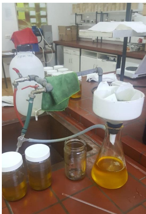
Slika 9 Vakuum filtracija sirovog ulja i proizvodnja hladno prešanog ulja Cameline sative
