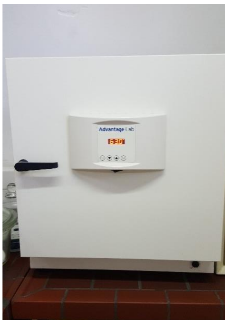
Slika 14 Sušionik zagrijan na 63°C
