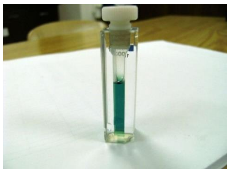
Slika 3.10. Obojenje nastalo oksidacijom ABTS-a lakazom
