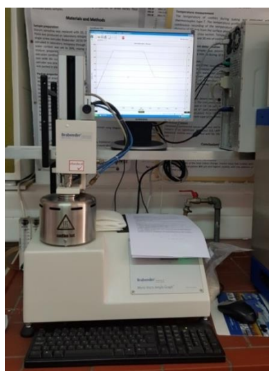
Slika 21 Brabenderov mikro visko-amilograf
