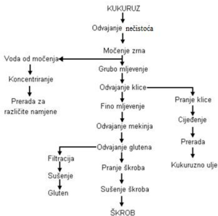
Slika 2 Shematski prikaz mokre prerade kukuruza (Šubarić i sur., 2011.)
