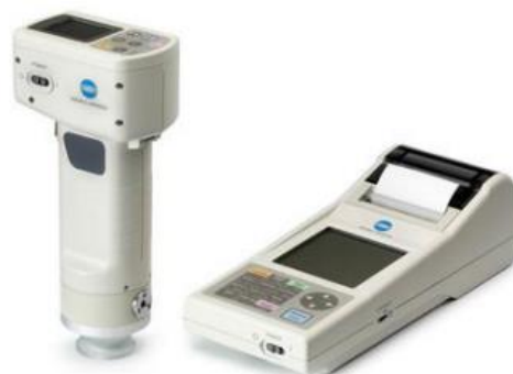
Slika 14 Kromametar Konica Minolta CR-400 (Jozinović, 2015.)
