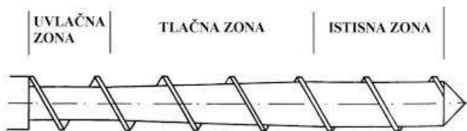
Slika 5 Presjek jednopužnog ekstrudera s odgovarajućim zonama (Web 4)
