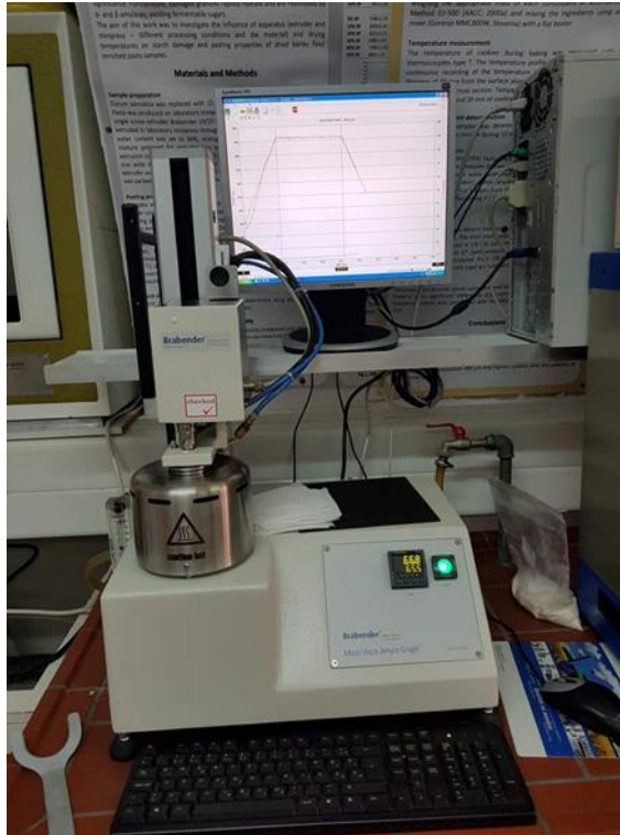
Slika 9 Brabenderov mikro visko-amilograf povezan s računalom (Brabender GmbH, Duisburg, Njemačka)
