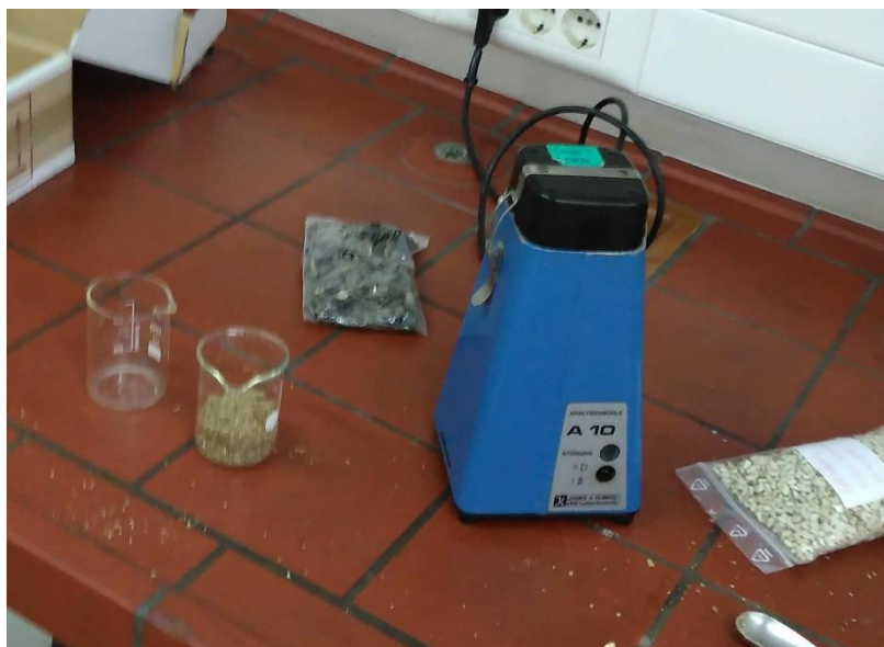
Slika 11 Laboratorijski mlin i samljevene pogače šafranike
