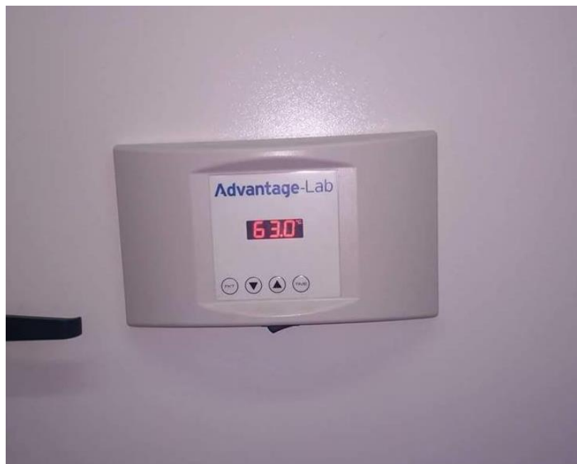
Slika 20 Ventilacijski sušionik s konstantnom temperaturom 63 °C
