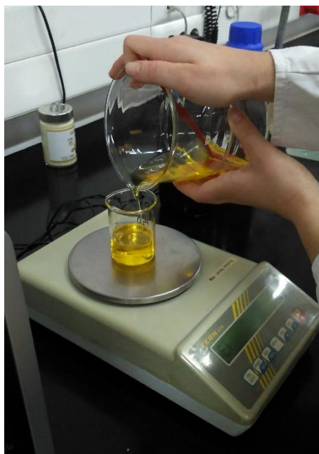
Slika 19 Priprema uzorka za ispitivanje oksidacijske stabilnosti ulja
