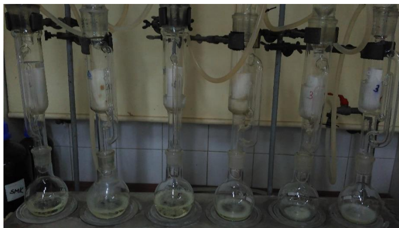
Slika 12 Ekstrakcija po Soxhlet-u
