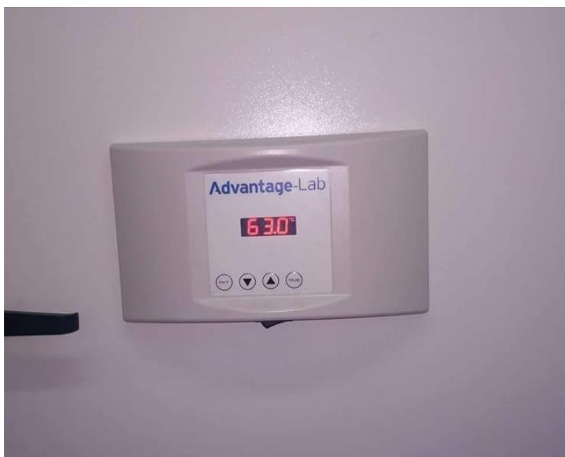
Slika 20 Ventilacijski sušionik s konstantnom temperaturom 63 °C
