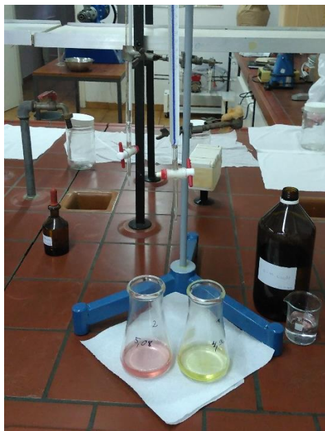
Slika 15 Titracija s NaOH
