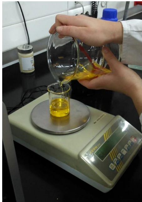
Slika 19 Priprema uzorka za ispitivanje oksidacijske stabilnosti ulja
