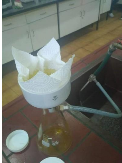
Slika 10 Vakum filtracija sirovog ulja preko Büchner-ovog lijevka
