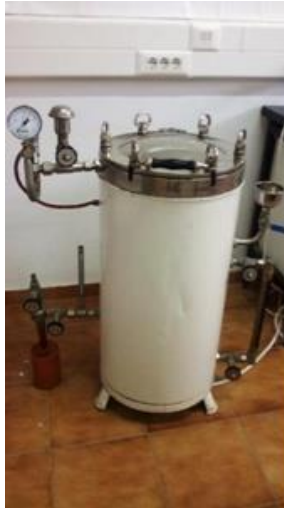
Slika 9 Autoklav TIP7510945, Sutjeska, Beograd
