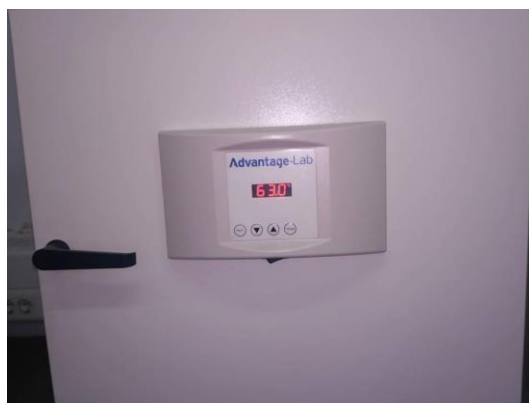
Slika 17 Sušionik zagrijan na 63°C
