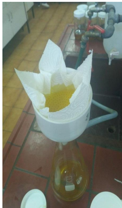
Slika 12 Vakuum filtracija sirovog ulja preko Büchner-ovog lijevka
