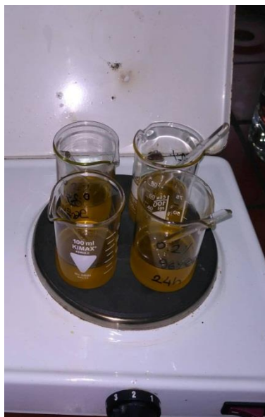
Slika 16 Zagrijavanje i miješanje uzorka s dodanim antioksidansima
