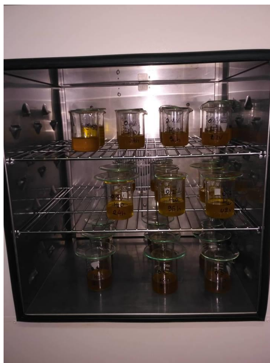
Slika 18 Uzorci ulja s antioksidansima termostatirani na 63°C u sušioniku
