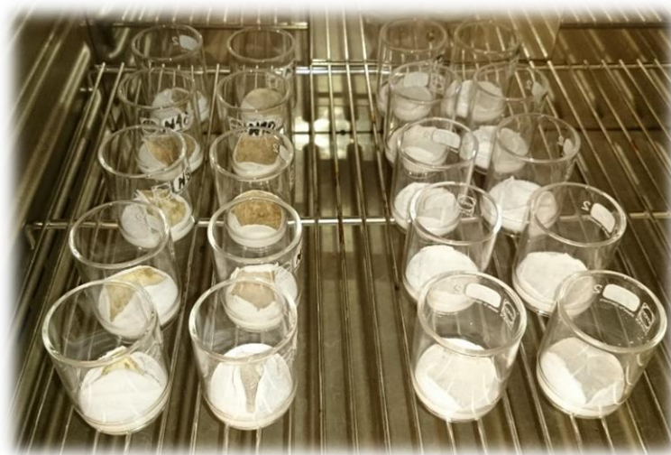
Slika 39 Sušenje sinteriranih lončića s netopljivim i topljivim vlaknima
