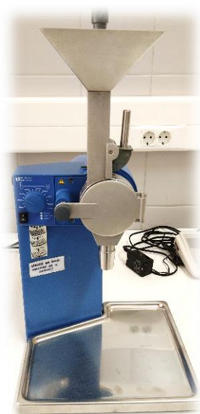
Slika 23 Laboratorijski mlin IKA MF10 (Staufen, Njemačka)
