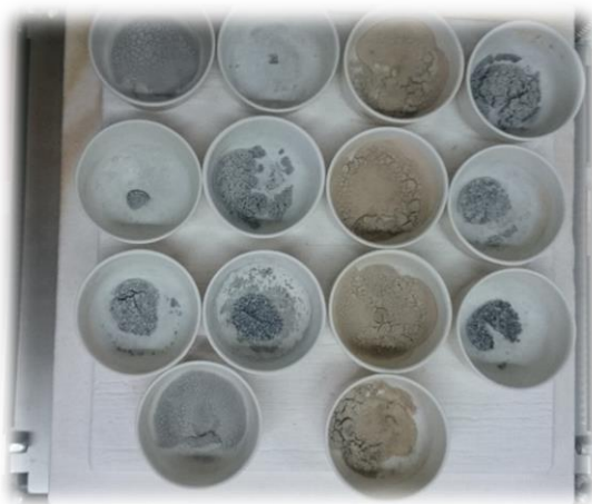
Slika 31 Hlađenje uzoraka na termorezistentnoj ploči nakon spaljivanja
