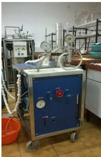
Slika 22 Laboratorijski uređaj za membransku filtraciju LabUnit M20.
