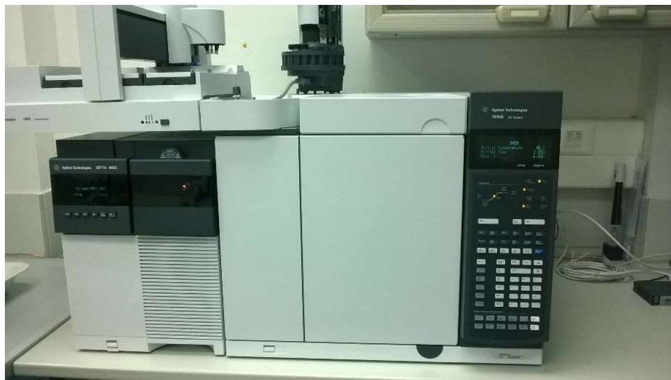
Slika 29 GC-MS analitički sustav.
