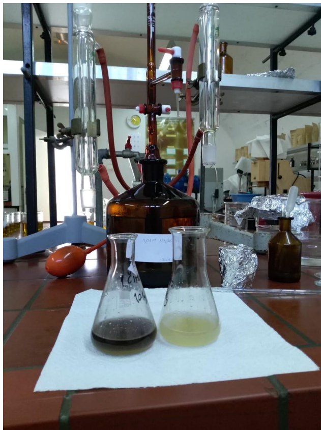
Slika 9 Titracija uzorka sa \text{Na}_2\text{S}_2\text{O}_3
