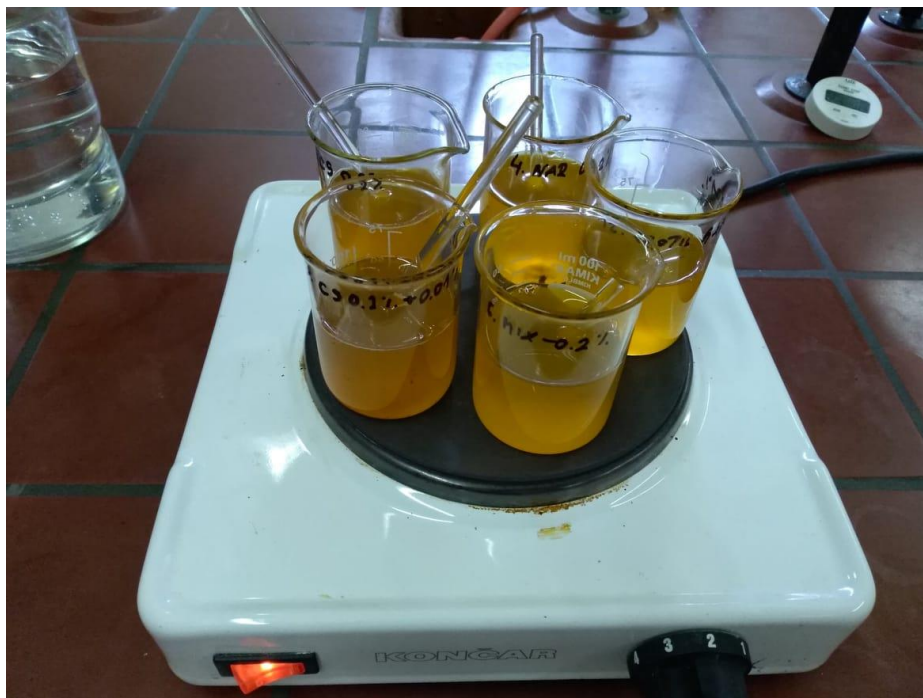
Slika 10 Priprema uzorka ulja s dodatkom antioksidanasa
