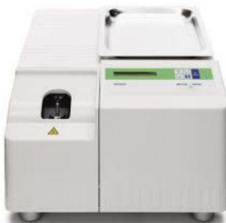
Slika 6 DMK kalorimetar tvrtke Mettler-Toledo model 822e
