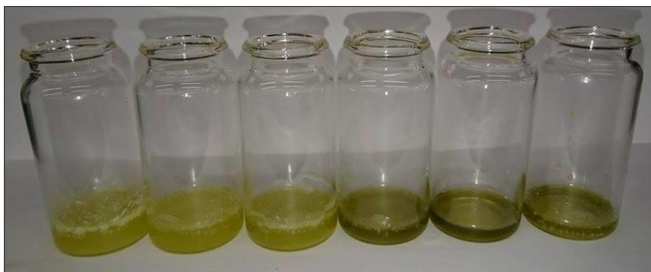
Slika 15 Fotografija ulja iz sjemenki grožđa dobivenog u različitim vremenskim intervalima tijekom ekstrakcije superkričnim CO 2
