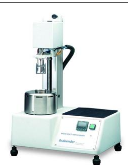
Slika 5 Micro Visco-amilograf (web prikaz 2)
