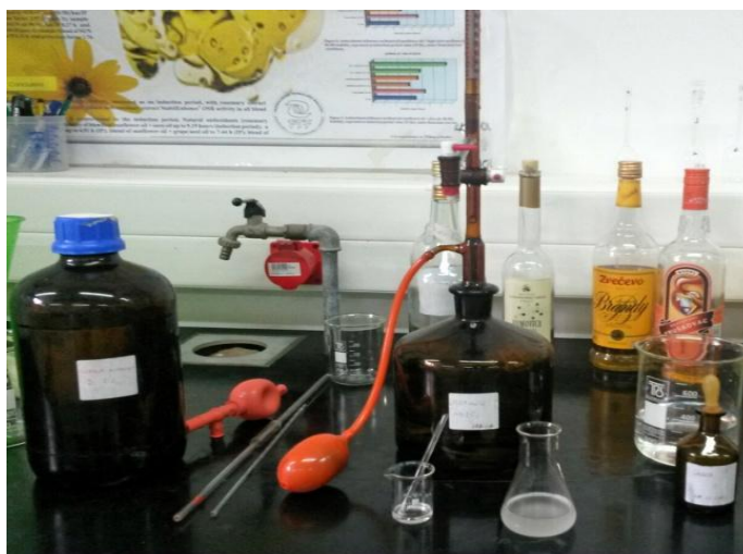
Slika 7 Određivanje peroksidnog broja
