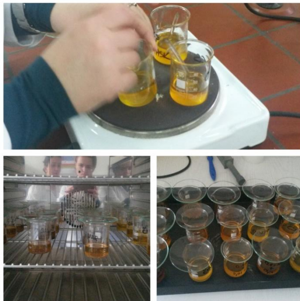
Slika 9 Priprema uzoraka ulja za Oven test
