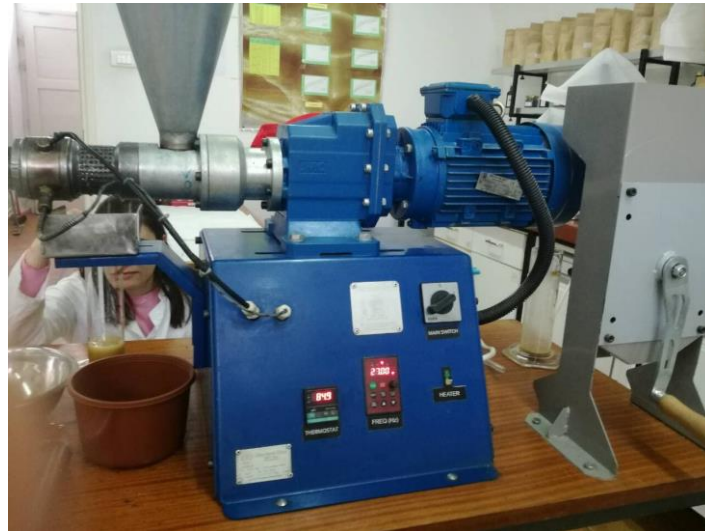
Slika 7 Kontinuirana pužna preša
