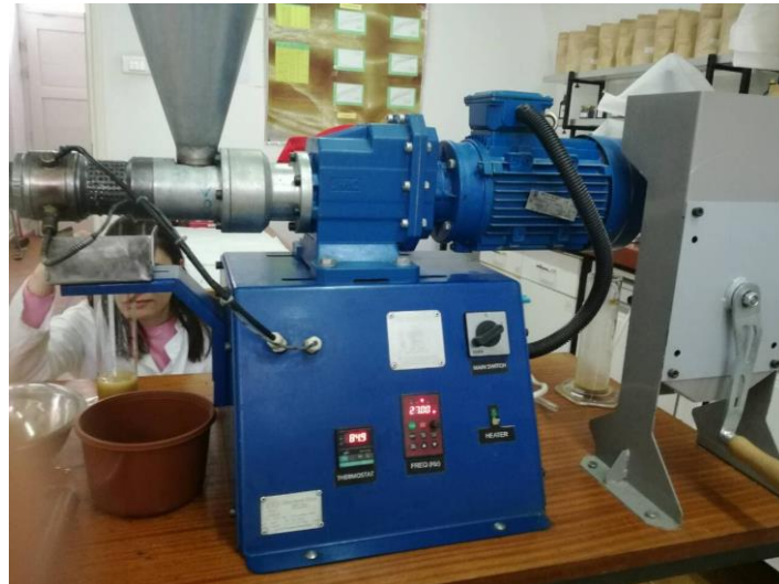
Slika 7 Kontinuirana pužna preša
