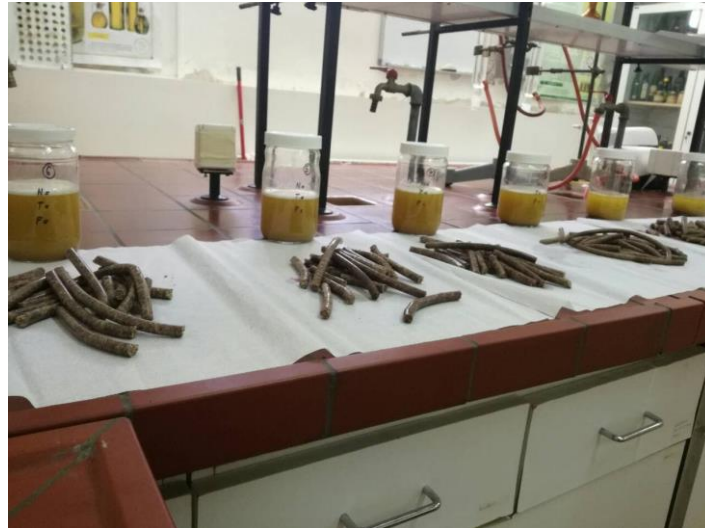
Slika 9 Sirovo ulje u staklenkama i pogača
