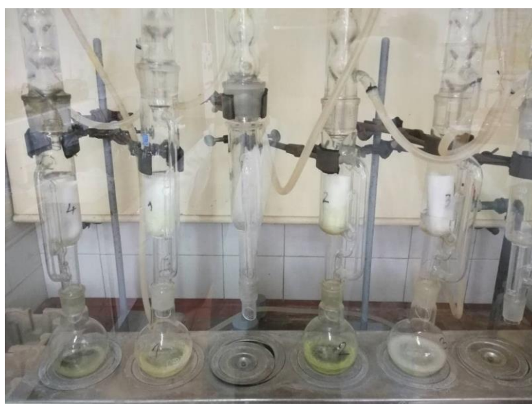
Slika 10 Ekstrakcija ulja po Soxhlet-u
