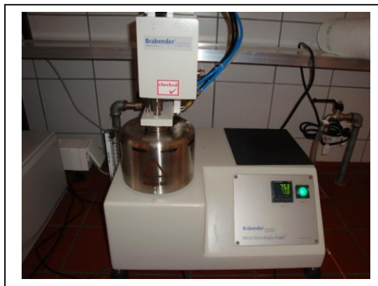
Slika 11 Brabenderov Mikro visko-analyzer (Jozinović, 2011.)
