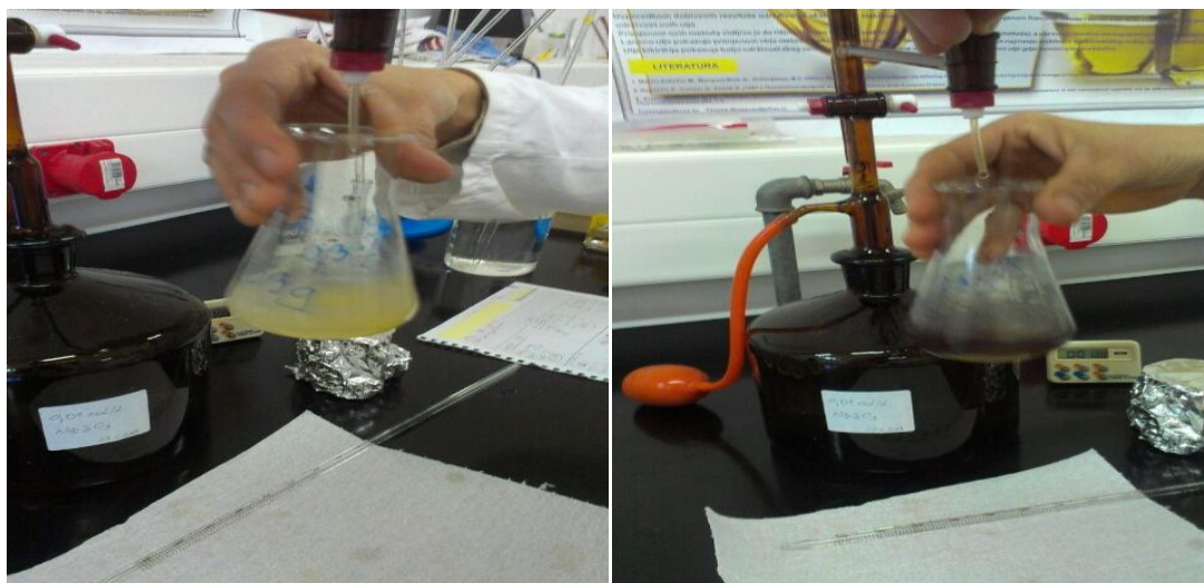
Slika 13 Promjena boje prilikom titracije određivanja peroksidnog broja
