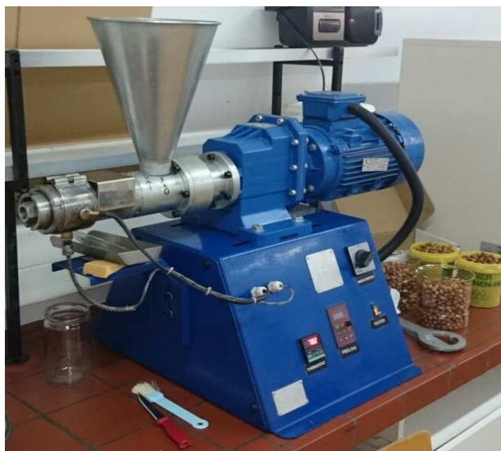
Slika 8 Pužna preša (SPU, 20)
