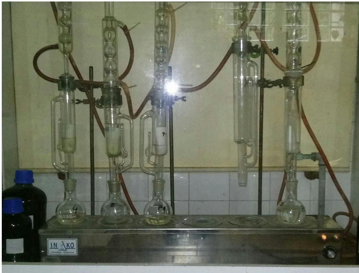
Slika 10 Aparatura za ekstrakciju po Soxhlet-u
