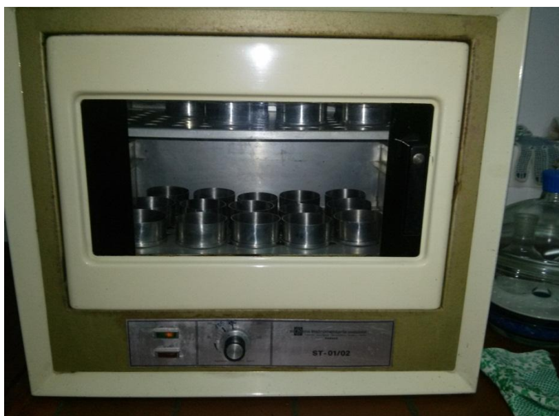
Slika 9 Posudice s poklopcima u kojima se nalaze uzorci ulja
