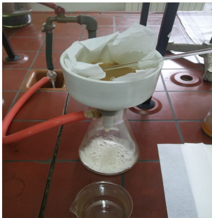
Slika 12 Vakuum filtracija sirovog ulja preko Büchner-ovog lijevka
