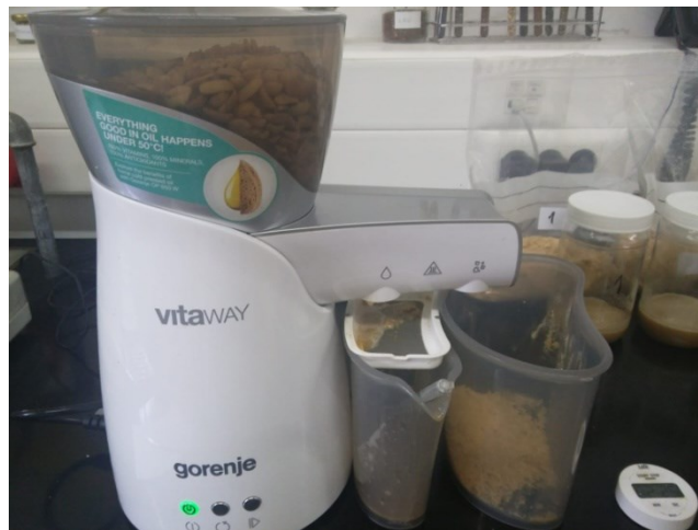
Slika 9 Laboratorijska pužna preša (OP-650W)
