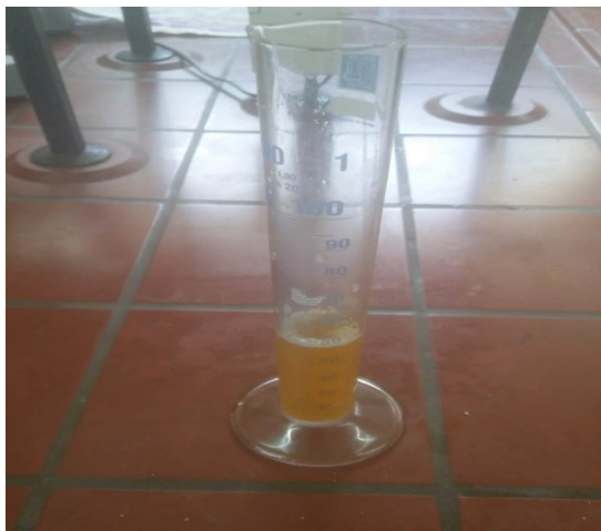
Slika 10 Mjerenje volumena i temperature sirovog ulja
