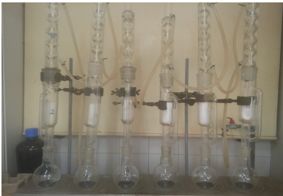
Slika 15 Ekstrakcija ulja metodom po Soxhlet-u
