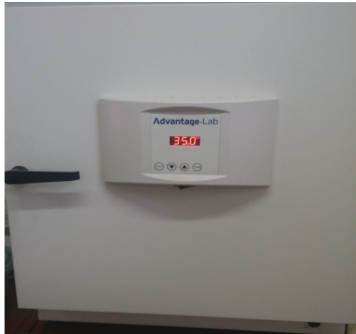
Slika 13 Sušionik za kondicioniranje jezgre kikirikija
