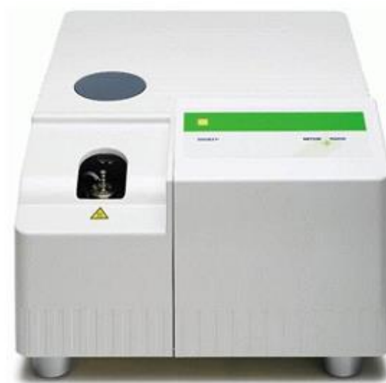
Slika 11. DSC kalorimetar tvrtke Mettler-Toledo model 822e
