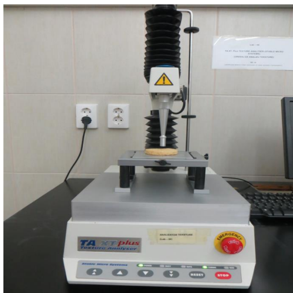
Slika 2. Analizator teksture TA.TX Plus s opremom za prodiranje u uzorak
