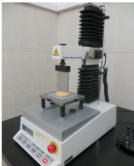
Slika 1. Analizator teksture TA.XT Plus s opremom za savijanje/lomljenje uzoraka
