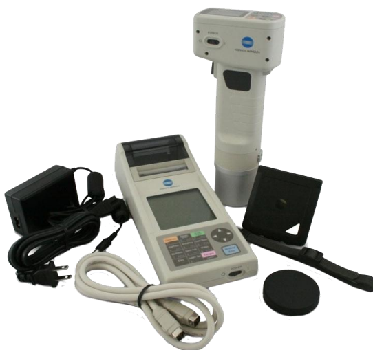
Slika 4 Kolorimetar Konica Minolta Chroma Meter CR-400
