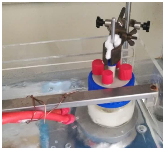
Slika 9 Sinteza biodizela u kotlastom bioreaktoru
