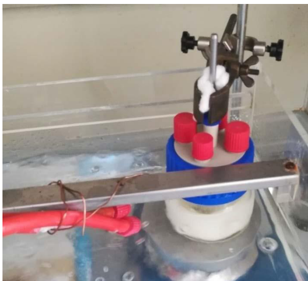
Slika 9 Sinteza biodizela u kotlastom bioreaktoru
