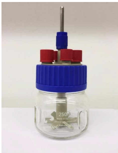
Slika 5 Kotlasti bioreaktor ( V = 250 \text{ mL} )
