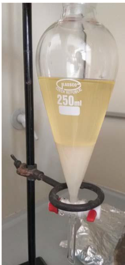
Slika 10 Razdvojene faze reakcijske smjese nakon 24 h odjeljivanja u lijevku za odjeljivanje
