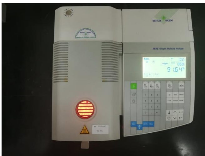
Slika 10. Uređaj za radijacijsko-infracrveno sušenje HR-73, Mettler Toledo
