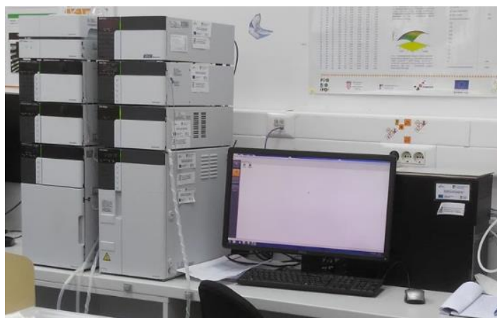
Slika 13. UHPLC spojen na računalo
