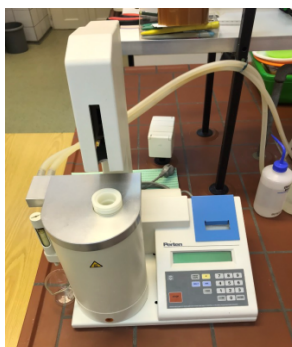
Slika 4 Uređaj po Hagberg-Pertenu za određivanje broja padanja
