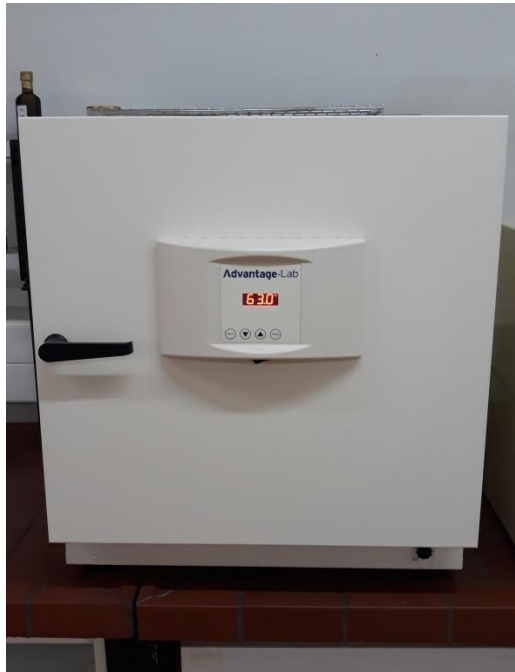
Slika 16 Sušionik za provedbu Oven testa na 63 °C
