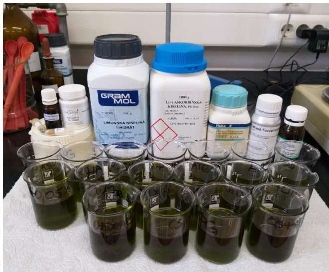
Slika 14 Pripremljeni uzorci i korišteni antioksidansi za provođenje Oven testa (Izvor: autor)
