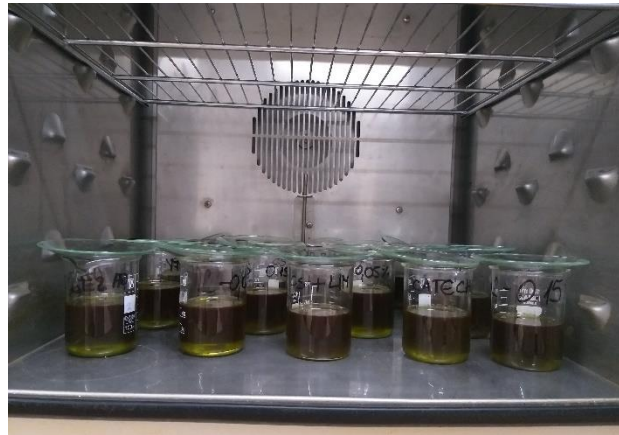
Slika 16 Pripremljeni uzorci u sušioniku za određivanje oksidacijske stabilnosti (Izvor: autor)
