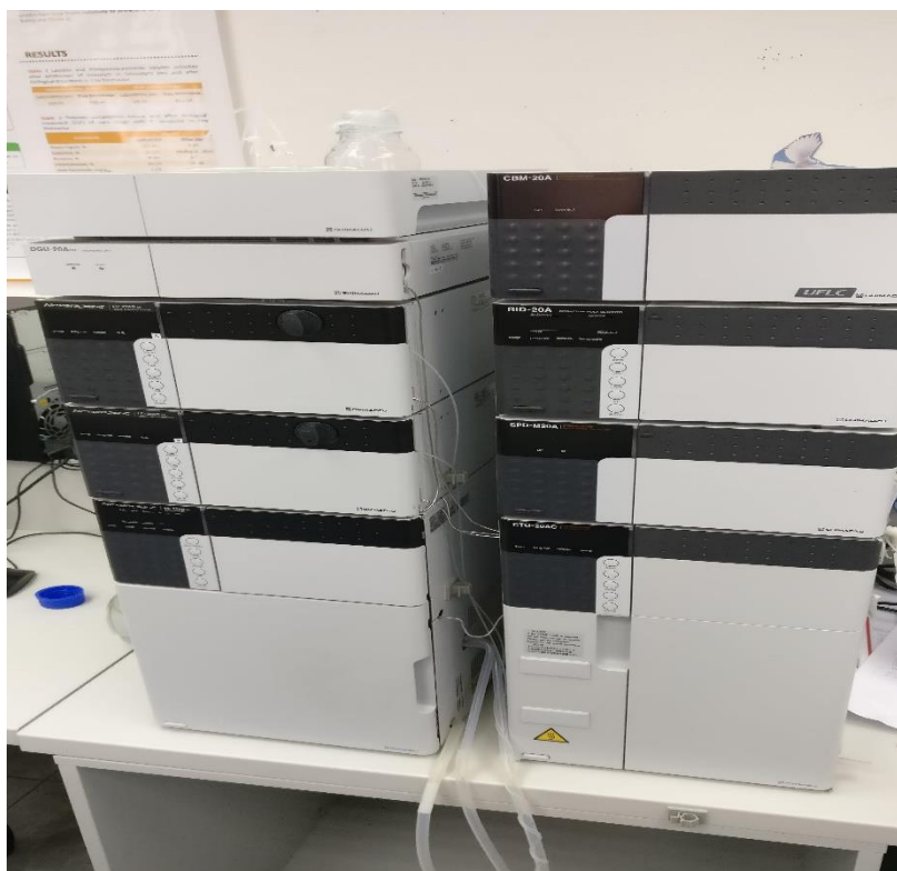
Slika 9 Nexera XR UHPLC, Shimadzu
