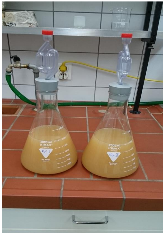
Slika 6. Pripremljeni uzorci u Erlenmayerovim tikvicama s vrenjačama
