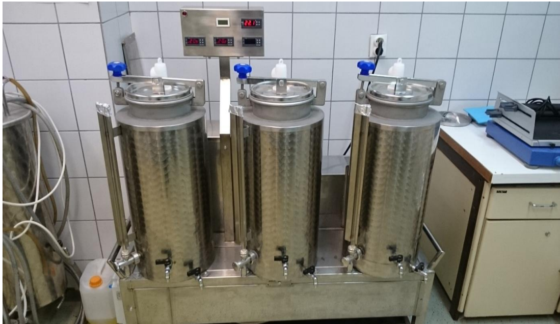
Slika 4. Sustav za kontroliranu fermentaciju
