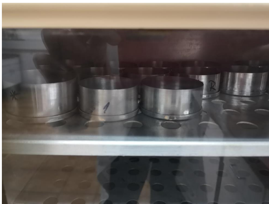
Slika 11 Sušenje otklopljenih posudica s uzorkom
