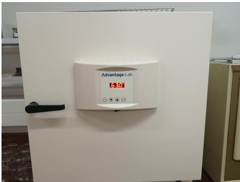
Slika 20 Prikaz termostata kod konstantne temperature provedbe testa pri 63 °C
