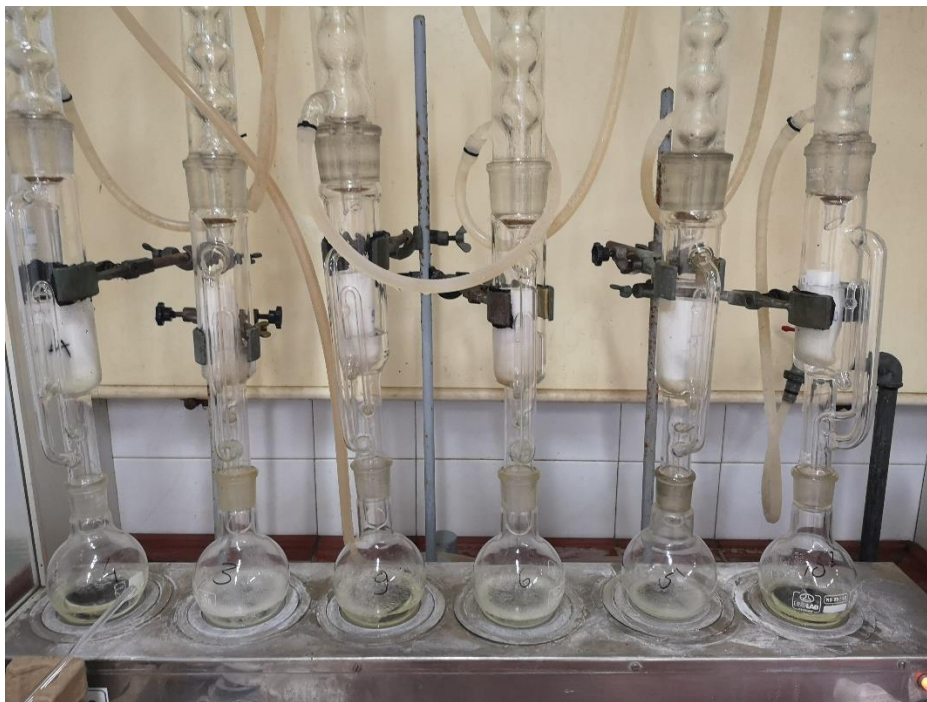
Slika 9 Ekstrakcija ulja po Soxhlet-u
