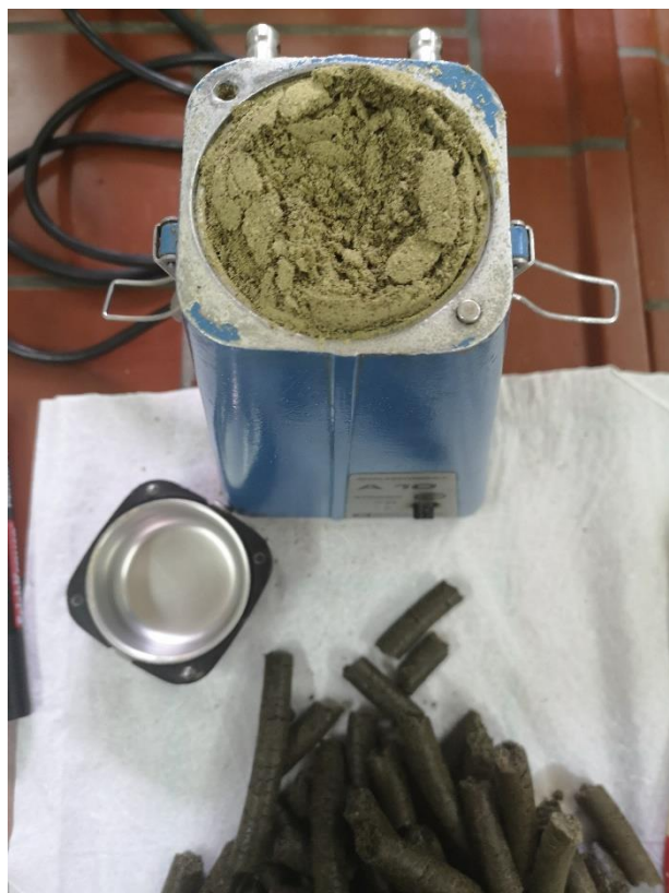
Slika 7 Mlin za mljevenje pogače i sjemenke konoplje
