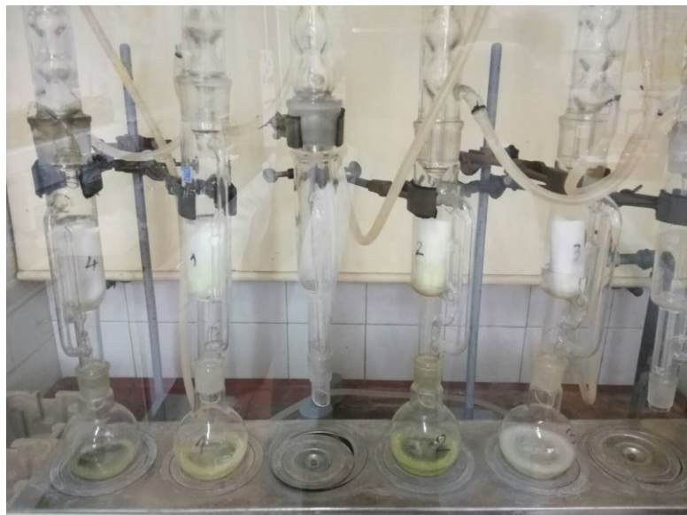
Slika 8 Ekstrakcija ulja po Soxhlet-u
