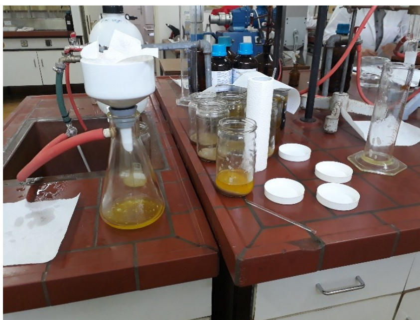
Slika 11 Vakuum filtracija sirovog ulja šafranike
