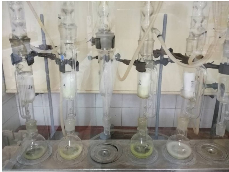
Slika 8 Ekstrakcija ulja po Soxhlet-u
