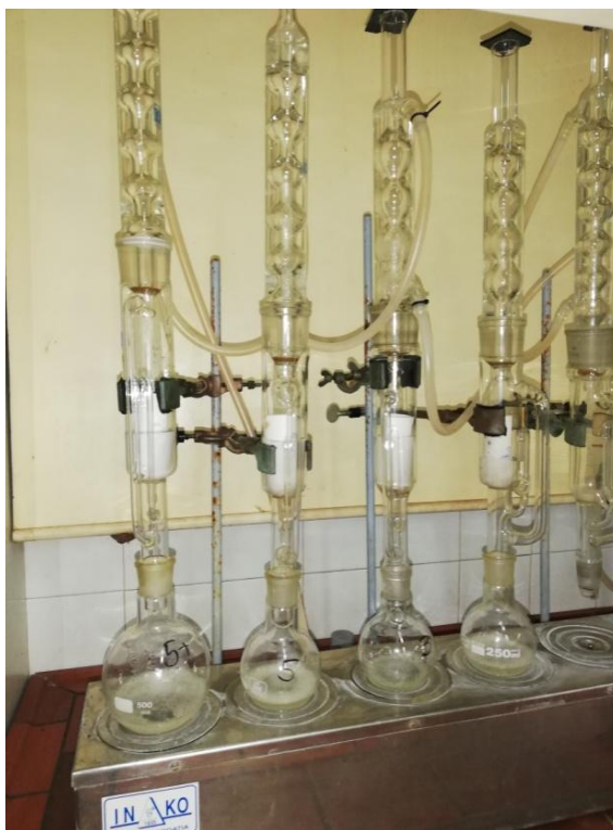
Slika 21 Aparatura za određivanje udjela ulja po Soxhlet-u
