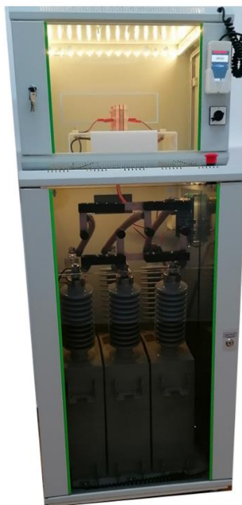
Slika 8 Uređaj za tretiranje hrane pulsirajućim električnim poljem (GROM)
