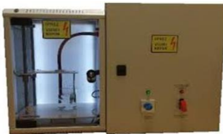
Slika 7 Uređaj za visokonaponsko električno pražnjenje
