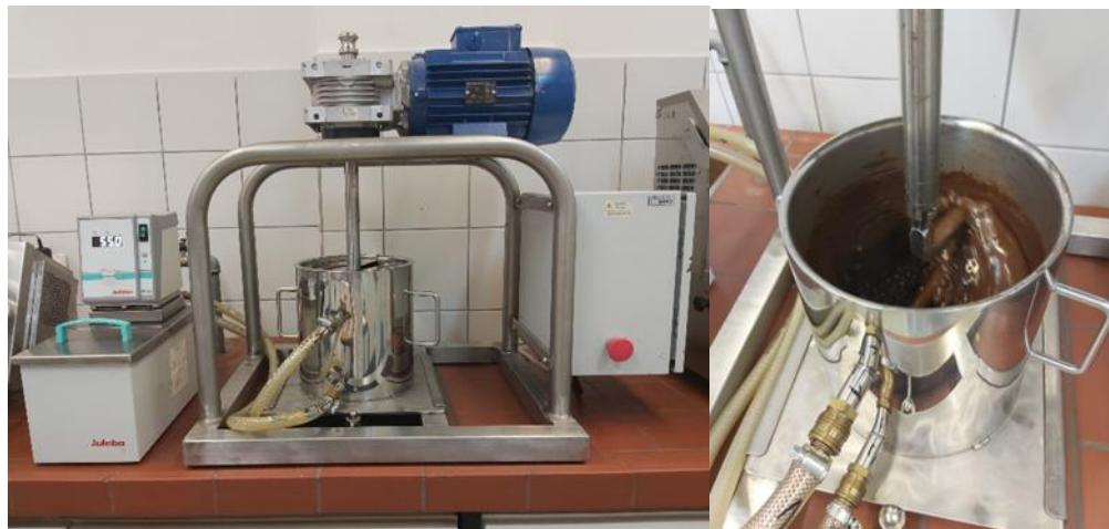
**Slika 11** Laboratorijski kuglični mlin
